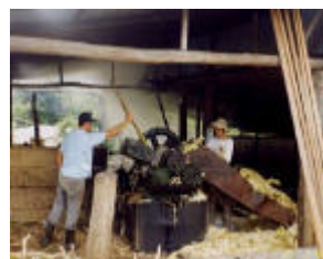
La combinación de engranajes pequeños y grandes hacen que el extractor mueva la caña lentamente.
