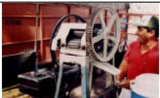
El Extractor prensa la caña, separando el jugo del bagazo.
