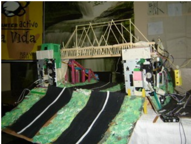
Fig. 2. Construcción de un puente peatonal que brinde los requisitos de accesibilidad y seguridad a la personas, de la comunidad de Desamparados. Creado por estudiantes entre 9 - 12 años, San José Costa Rica, mayo 2006 usando materiales rehusados y extraídos de computadores en desuso. Fue programado con Logo Blocas y controlado con Handy críquet.
