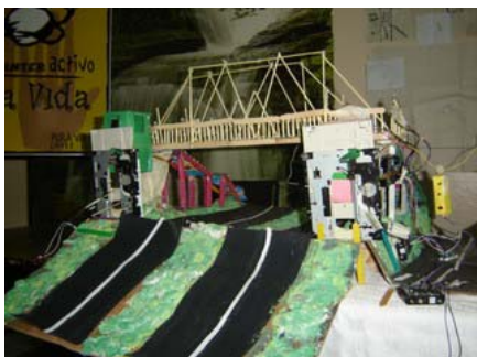
Fig. 2. Construcción de un puente peatonal que brinde los requisitos de accesibilidad y seguridad a las personas, de la comunidad. Creado por un grupo de estudiantes entre 9 - 12 años, fue construido con materiales re-usados extraídos de computadores en desuso, programado con Logo Blocks y controlado con handy cricket. San José Costa Rica, mayo 2006.
